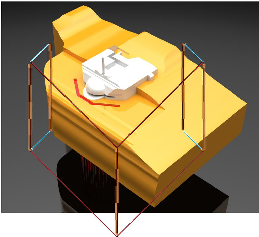
Un dispositif de surveillance de la stabilité de la falaise sera mis en oeuvre lors des travaux. Une surveillance des phénomènes géologiques et hydrauliques se fera par des capteurs et des sondes sur plusieurs années. Pour suivre l'évolution de la dégradation du massif rocheux autour du blockhaus, une centrale reliera l'ensemble des capteurs.
