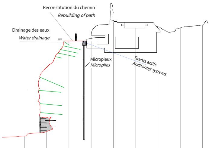
Des tubes métalliques verticaux seront mis en œuvre autour du blockhaus. Ces inclusions rigides, de 25 centimètres de diamètre et de 24 mètres de longueur, vont s'encastrer dans les terres compactes de la falaise afin de maintenir le sol sous l'ouvrage historique. Le sentier devant le blockhaus sera reconstitué à la fin des travaux.
